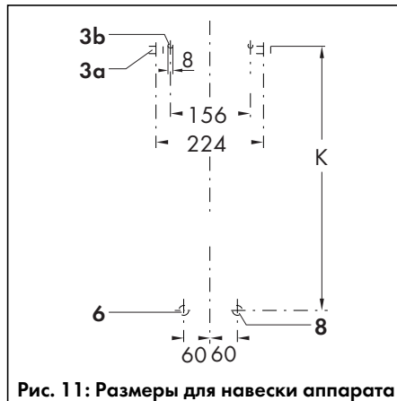
Рис. 11: Размеры для навески аппарата
