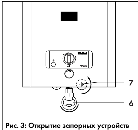
Рис. 3: Открытие запорных устройств
